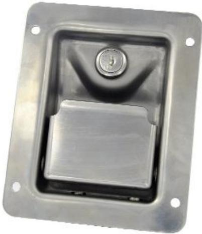
这种隔舱门锁适用于轻度负荷至中度负荷储物舱和车厢门。本产品具有抛光不锈钢或带镀层低碳钢型号，具有便于远程致动的 2 点曲柄，可以电动锁定。
